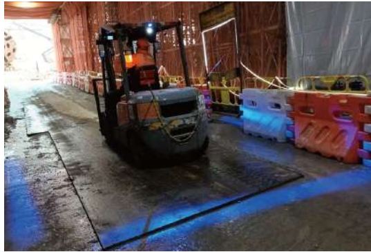
圖24-為流動機械安裝射燈以識別危險區域
