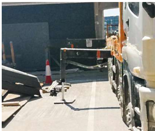
圖15-支撐腳均已標記及塗漆以標示完全伸展的位置
