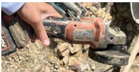
圖3-電磨機未有裝上合適的把手 及 電磨機已裝上合適的把手及護罩
