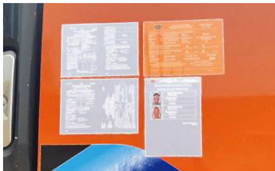
圖21-挖土機使用前均由合資格檢驗員測試和徹底檢驗，並展示有效的法定表格四
